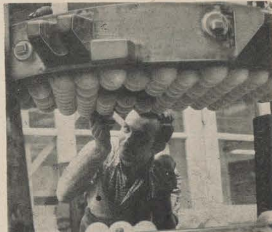
Die Tennisbälle werden aus dem Autoklav herausgenommen und anschließend gedämpft. Fotos: Kronfeld
