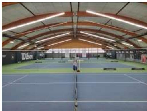
**4-Feldhalle mit Tonnendach – Spielklasse I (750 lx) – dem Dachverlauf folgendes Lichtband – Lichtsteuerung DALI**
