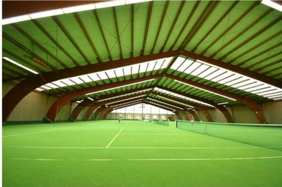
*2x 4-Feldhallen – Spielklasse II (573 lx) – Lichtband dem Dachverlauf folgend – Lichtsteuerung (DALI), Tageslicht und nutzerabhängig*
