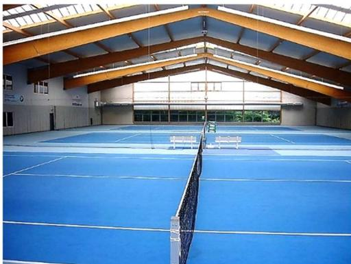
**3-Feldhalle – Spielklasse I (750 lx) – dem Dachverlauf folgendes Lichtband – Lichtsteuerung DALI; ermöglicht u.a. ein bedarfsgerechtes Umschalten zwischen Spielklasse I und II**
