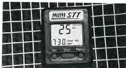
Mit dem Mini-STT kann man die Spannungshärte messen
